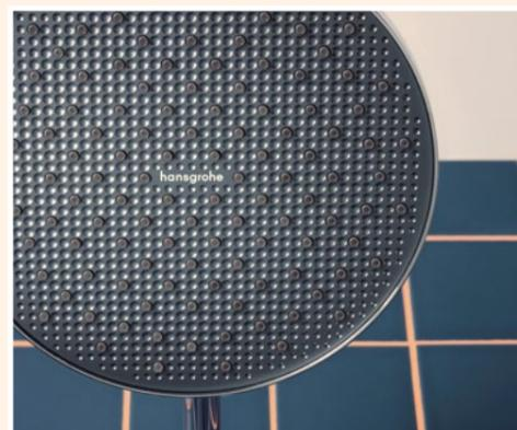
**Die FlexPower Technologie** sorgt bei niedrigem oder schwankendem Wasserdruck für stabile Performance und kraftvolle Wasserstrahlen. Dafür sind die elastischen Flex-Düsen in der Strahlscheibe wie ein Kleeblatt geformt, das mit stetigen dynamischen Bewegungen für Druckausgleich sorgt. So haftet auch weniger Kalk an, was den Putzaufwand verringern kann.
